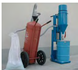
RIEMPIMENTO DI ESTINTORE CARRELLATO CON KIT "VENTURI"
