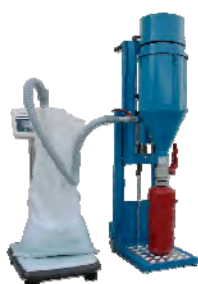
RIEMPIMENTO DI ESTINTORE PORTATILE
